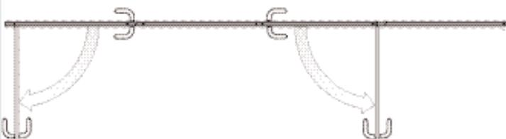
Конечная панель-дверь одинарного действия
