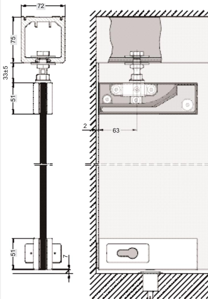
Может быть использована как передвижная панель при замене на роликовые каретки.
