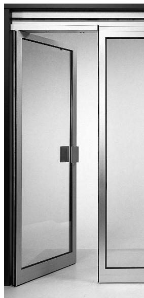
Прочная профильная рама с верхними, боковыми и нижними уплотняющими щетками для надежной защиты от внешних воздействий, погоды и теплопотери. Может использоваться с закаленным стеклом, закаленным триплексом или специальным стеклом; стандартные профили 8 и 22 мм., другие толщины профиля см. в приложении
