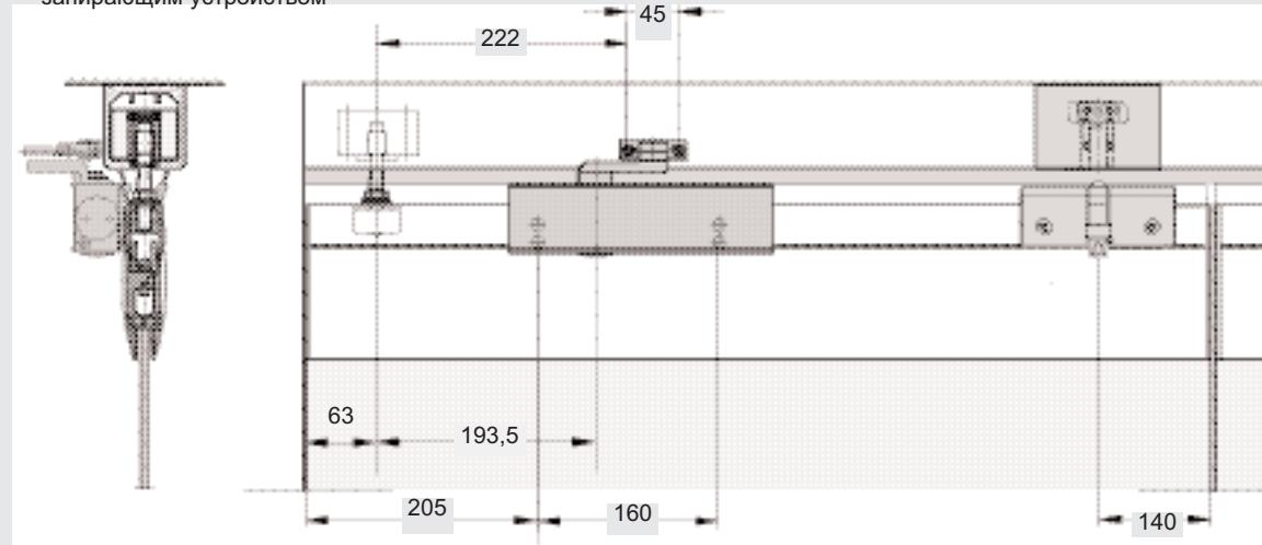
Конечная панель одинарного действия с доводчиком TS72 и дополнительным запирающим устройством
