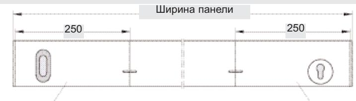
Дверная шина со встроенными элементами
