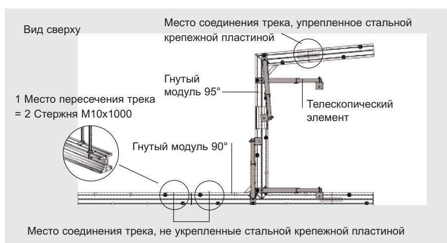
При использовании стальных крепежных пластин в местах соединения трека, достаточно использовать только одну точку подвеса.
