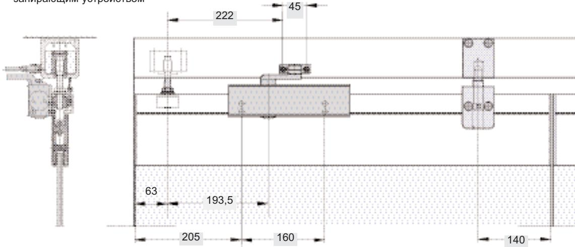
Конечная панель одинарного действия с доводчиком TS 92 и дополнительным запирающим устройством
