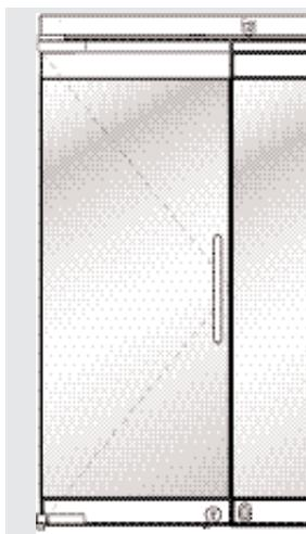
Панель-дверь с выносной осью может поворачиваться на угол 180°. Данная дверь может фиксироваться нижним замком.
