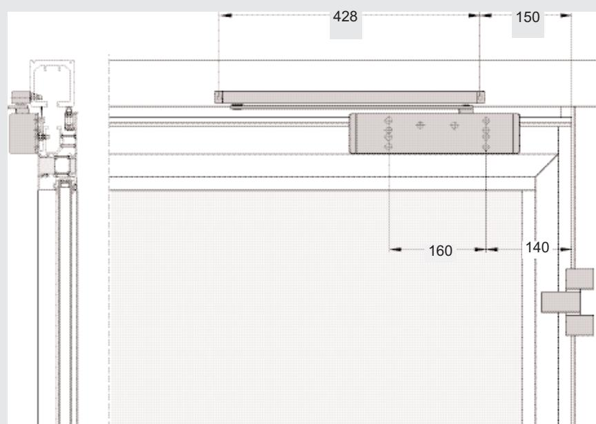
Конечная панель-дверь, крепление к стене
