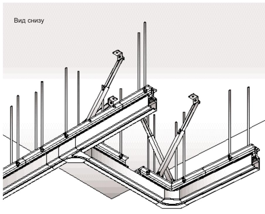
Парковочная зона, состоящая из подконструкции и рельса трека, показывает как может быть использована эта система. Отдельные компоненты системы работают вместе, образовывая надежную и прочную систему.
