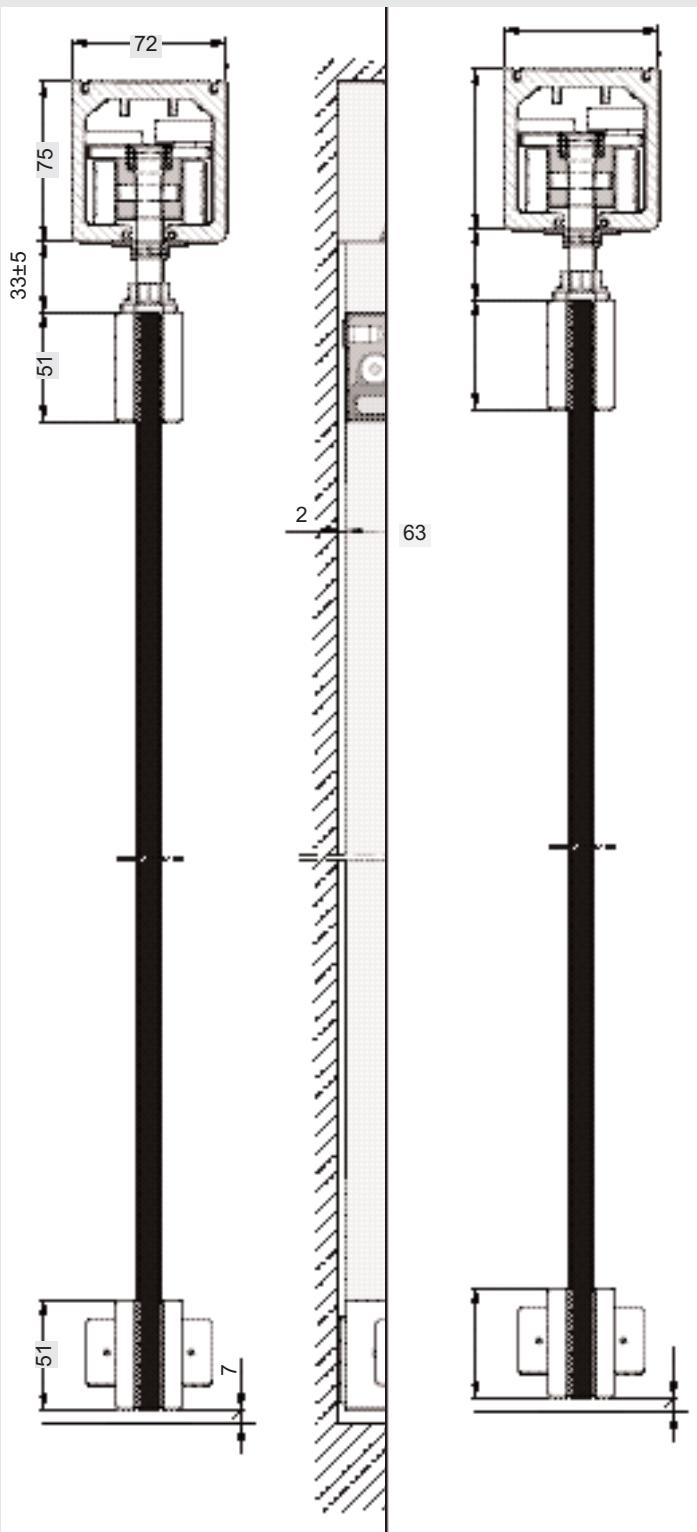
Следующая панель с ответной частью для бокового шпинделя
