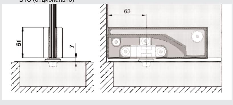
Конечная панель двойного действия, не передвижная. В стандартной комплектации оборудуется верхней осью, нижним запирающим устройством (в пол), с полным евроцилиндром) и нижней осью со шпинделем. Дополнительно, вместо нижней оси может использоваться нижний доводчик BTS 84 'Z'. Этот доводчик подходит для панелей до 100 кг. и может поставляться с устройством для фиксации в открытом положении на 90°.
