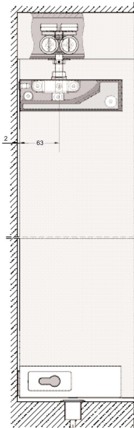
Следующая панель с нижним боковым шпинделем
