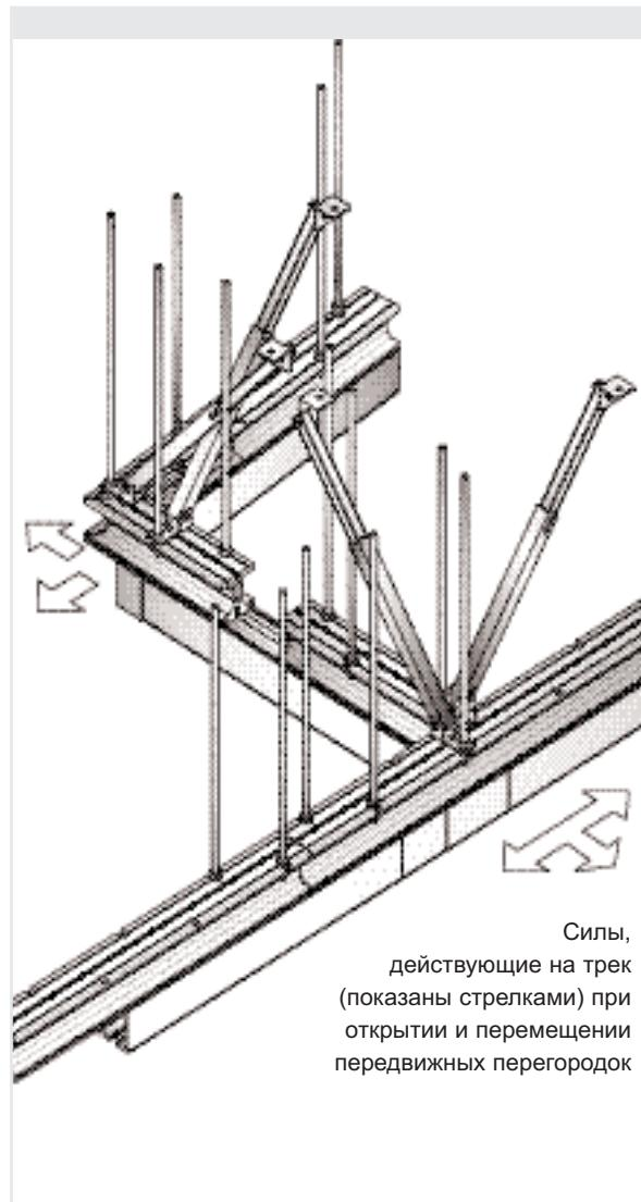
Силы, действующие на трек (показаны стрелками) при открытии и перемещении передвижных перегородок
