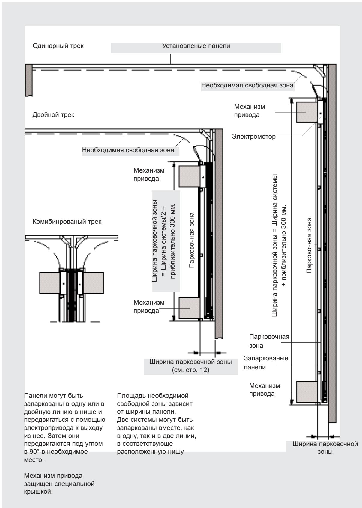
Размеры для парковки в ниши (автоматических или ручного типа)
