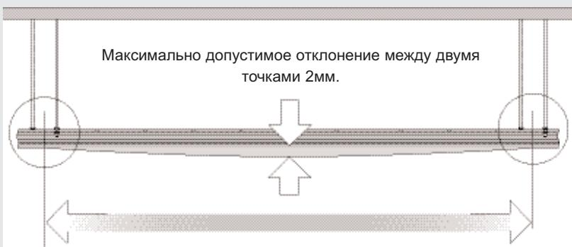
Для предотвращения качания системы рекомендуется использовать подпорки через одну точку крепления. Также рекомендуется закреплять края подконструкции (в зоне перемещения и зоне парковки) непосредственно к потолку или к другим структурным элементам.
